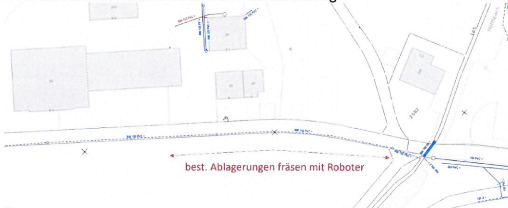
Übersicht bestehende Ablagerungen in Sauberwasserleitung
